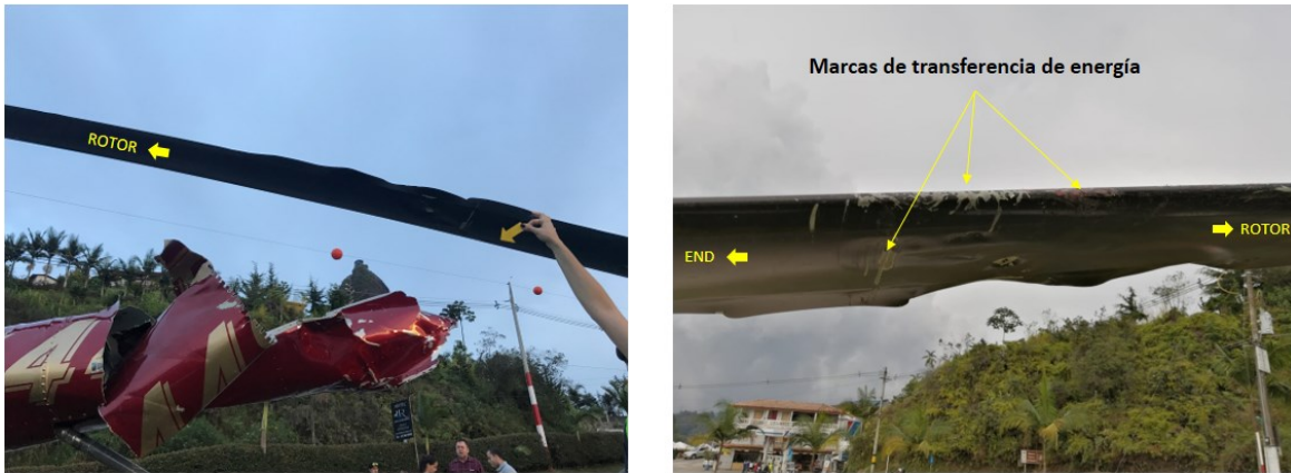
Fotografía No. 3 – Aspecto general de las palas del rotor principal y muestras de transferencia de energía
