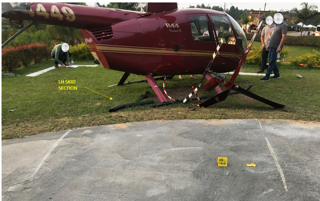
Fotografía No. 4 – Marcas en el terreno durante la dinámica de trayectoria a la posición final
