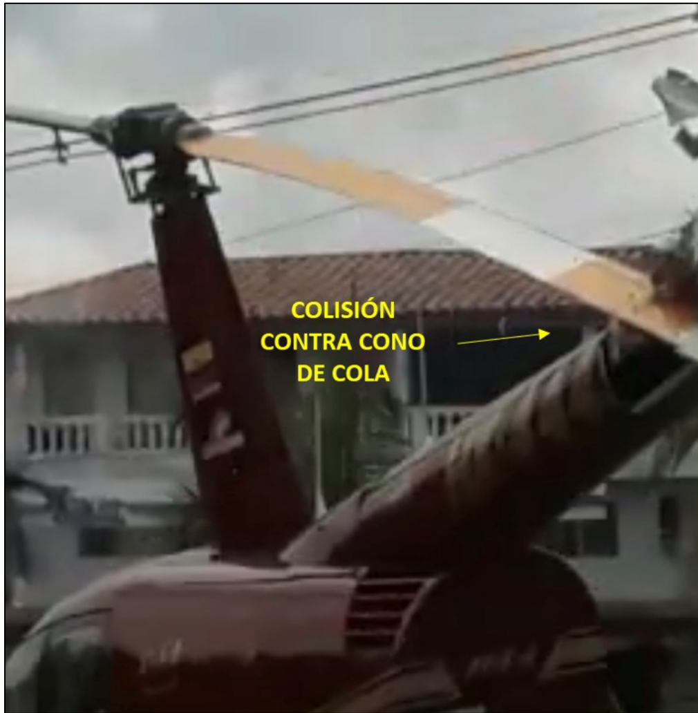
Imagen No. 1 – Fotograma del video en el momento donde se presentó el golpe de las palas del rotor principal con el cono de cola HK4449 (Tiempo video: 00.06 s)
